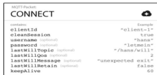
Fig. 4. MQTT message format
